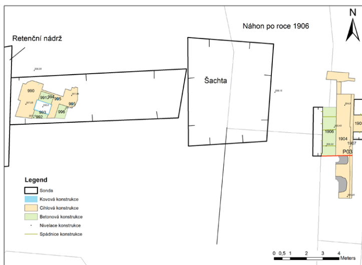
Obr. 20: Plán části interiéru čerpací stanice s.j. 990–995 (vlevo) a východní běh náhonu s obvodovým zdívem mlýna s.j. 1904 a mladším skluzem s.j. 1906 (vpravo)
