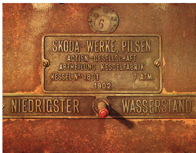
Obr. 5: Výrobní štítek jednoho z parních kotlů – výrobků firmy Škoda. Foto: Amideria Chiozza
