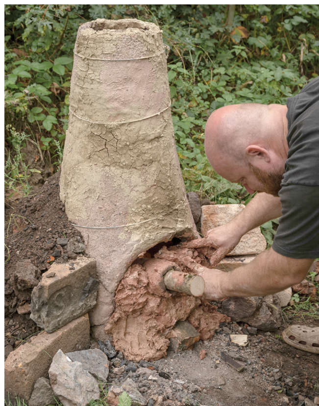
Obr. 8: Uzavírání pracovního prostoru kusové železářské pece. Není použit dyznový panel, ale pouze žáruvzdorný jíl, do něhož je v tomto případě vložena přímo dyzna. Stará huť u Adamova, září 2023. Foto: M. Barák
