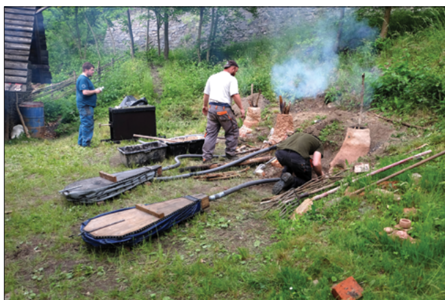
Obr. 1: Stará huť u Adamova, 27. května 2022, pomalé vysoušení pece. V popředí dva obvyklé měchy ještě bez vztyčených trojnožek, za nimi (černá krabice) měch japonské konstrukce. Foto: Ondřej Merta
