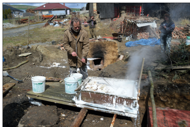
Obr. 6: Hašení vápna po skončení výpalu a vychladnutí pece. Foto: P. Kos
