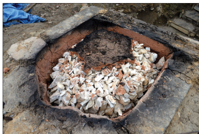
Obr. 5: Výsledek výpalu po částečném odebrání hliněného čepce. Foto: P. Kos
