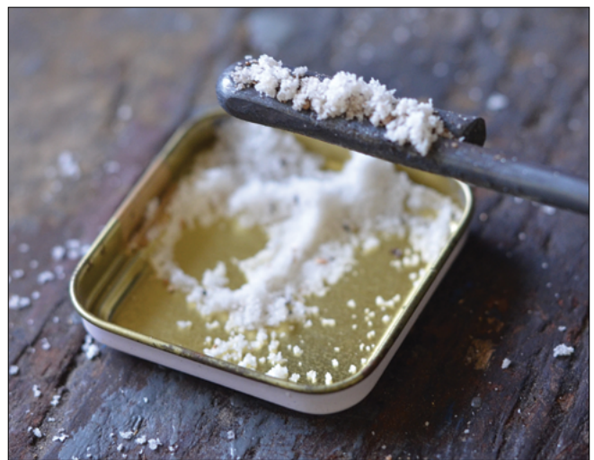
Obr. 1: Ohnutá kulatina pokrytá drtí tavidla. Foto: M. Hlavica
