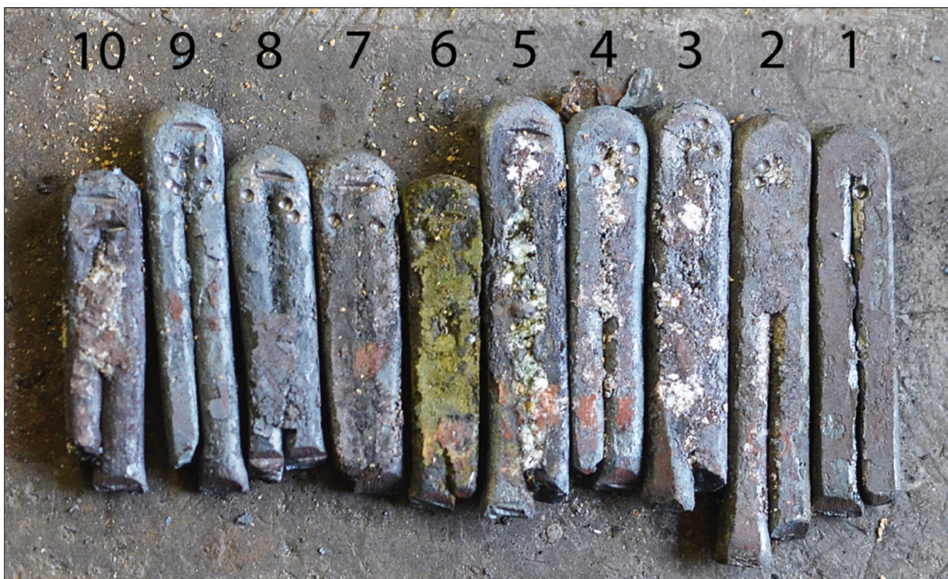
Obr. 2: Experimentálně svažené vzorky s různými typy tavidel. Foto: M. Hlavica
