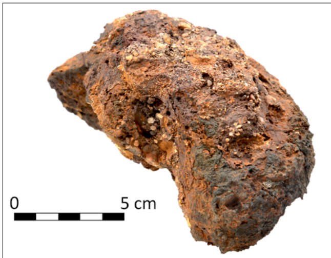
Obr. 7: Lupa Mikulčice 3 byla nalezena jako kompletní, k oddělení části došlo v souvislosti s přípravou vzorku pro metalografický průzkum tohoto nekvalitního polotovaru. Foto: Michael Lebsak
