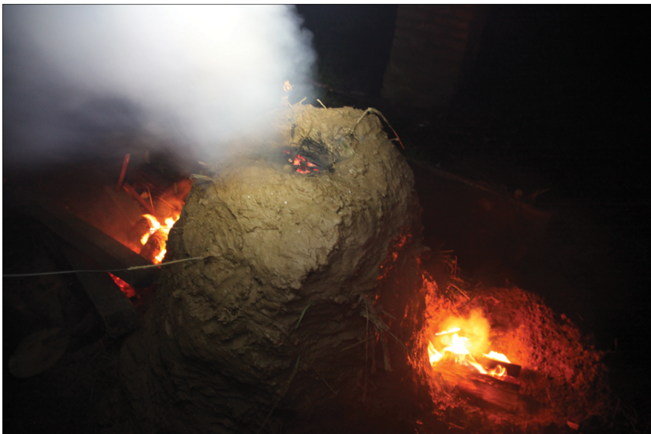
Obr. 5: Zažehnutý milíř s dobře patrnými topeništi a komínem. Foto: P. Macků 2021
