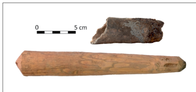
Obr. 12: Les Nevěrný, katastrální území Jasinov, okr. Blansko. Dyzna č. 42 a trn používaný k výrobě dyzen k experimentálním tavbám na Staré huti u Adamova. Na dyzně je patrný ne zcela pravidelný tvar vnějšího povrchu daný způsobem výroby, struskový povlak ústí, šedě vypálená hmota i tenká vrstva jílového materiálu, vzniklá při finální úpravě povrchu dyzny. Foto: Martin Barák
