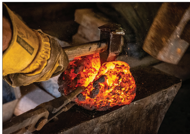
Obr. 4: Stará huť u Adamova, září 2020. Dělení železné lupy – počátek výroby sekyrovité železné hřivny. Foto: M. Barák
