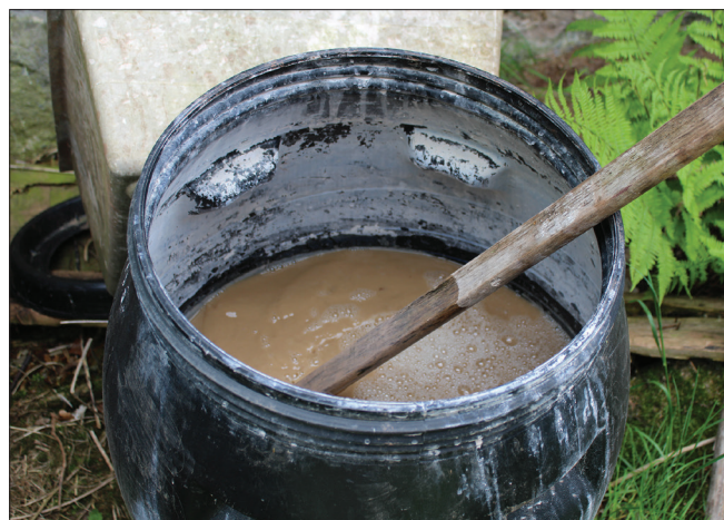
Obr. 1: Loužení kůží v roztoku vápna a popele. Fotografie pořízená v amatérské koželužně pana Kavana. Foto: archiv autora
