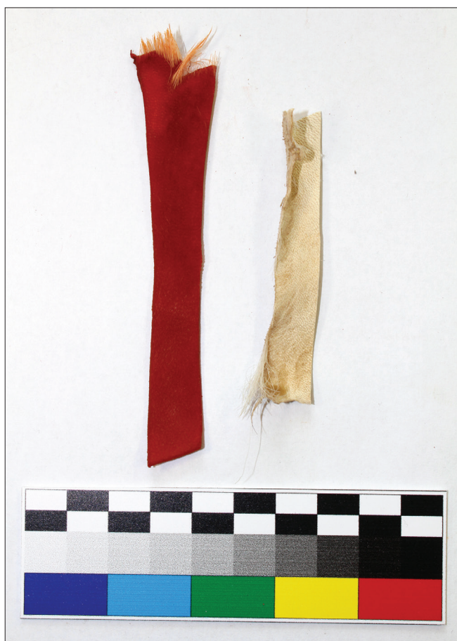
Obr. 6: Pokusné barvení jirchy / kamencové usně na červeno. Mořena barvířská ( Rubia Tinctorum L.) vařená s kamencem na vlevo, vpravo je nebarvená useň. Foto: J. Figura
