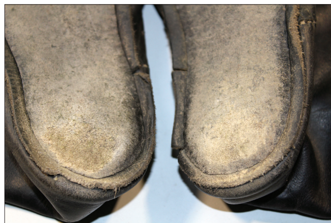
Obr. 21: Opatřebení paty dětské obuvi po týdnu při chůzi ve městech vsích i lesních a polních cestách. Foto: J. Figura
