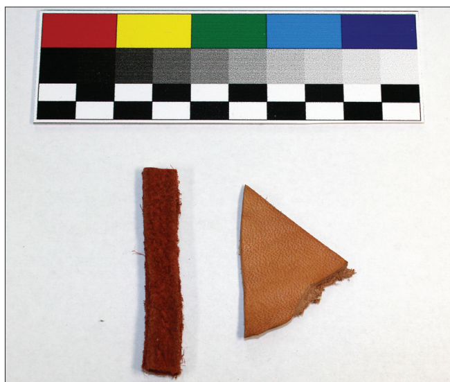
Obr. 8: Pokusné barvení moderních chromočinných usní. Mořena barvířská ( Rubia Tinctorum L.) vařená s kamencem. Foto: J. Figura
