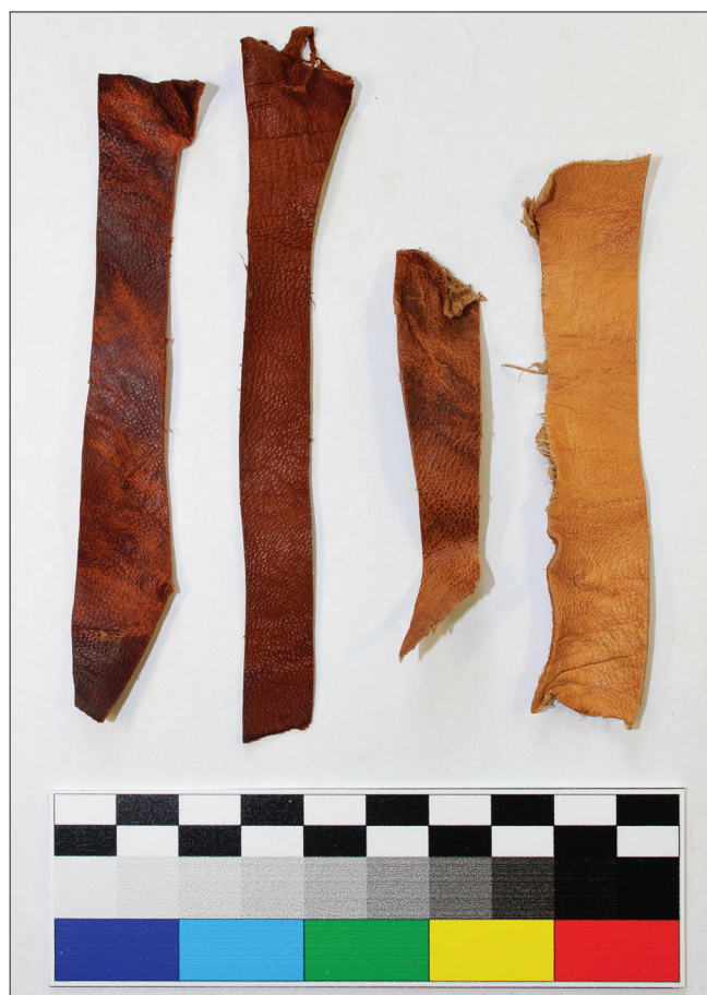
Obr. 7: Pokusné barvení tříslučiněné usně. Mořena barvířská ( Rubia Tinctorum L.) vařená s kamencem. První dvě usně od leva jsou barvené, další dva kusy usní jsou nebarvené. Foto: J. Figura
