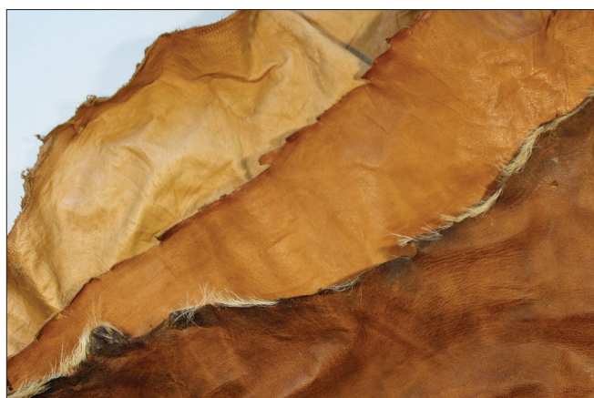
Obr. 4: Různé zabarvení kozích tříslučiněných usní z dílny pana Kavana. Foto: archiv autora
