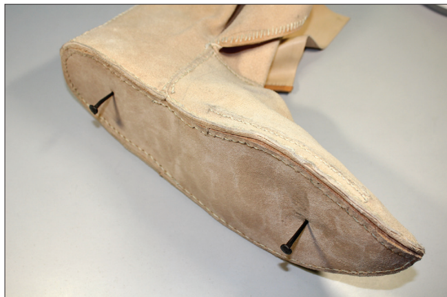
Obr. 28: Připevnění svršku a spodku na kopyto hřebíčky. Foto: J. Figura
