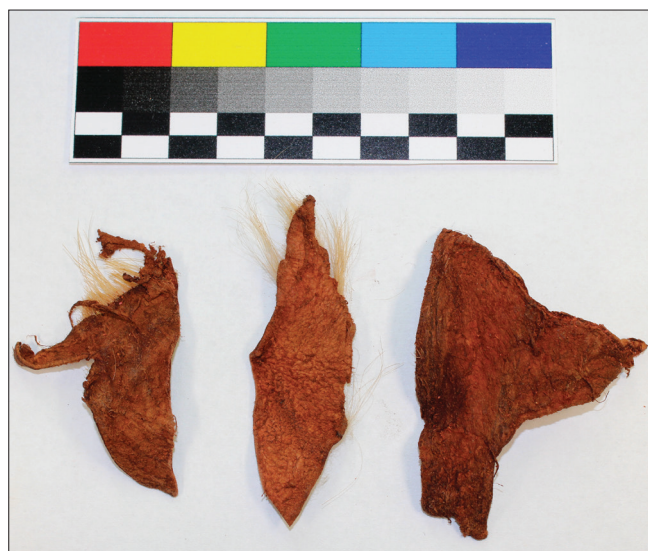
Obr. 9: Pokusné barvení tříslučiněné usně. Mořena barvířská ( Rubia Tinctorum L.) vařená s kamencem. Tříslučiněné usně, máčené v kamenci několik dní, barvené v lázni. Barvivo se navázalo zřetelně pouze na rubovou část. Foto: J. Figura
