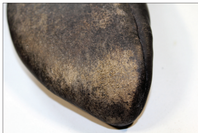
Obr. 22: Opatřebení u obuvi dospělého muže, po týdnu intenzivního užívání. Foto: J. Figura
