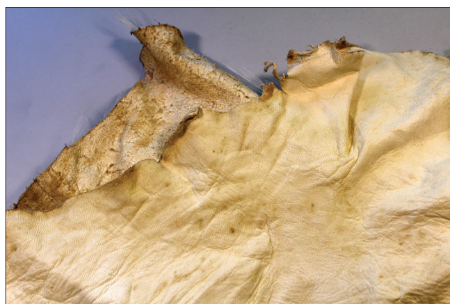
Obr. 5: Jircha / kamencové činění. Usně z kozí kůže z dílny pana Kavana. Foto: archiv autora
