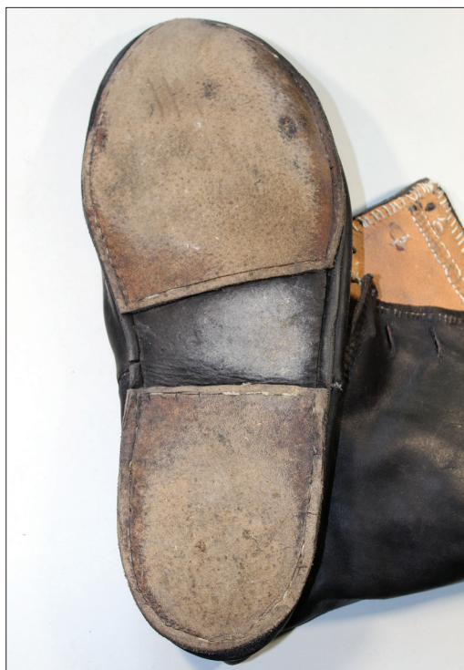
Obr. 25: Záplaty na mužské obuvi po týdenním intenzivním používání.
