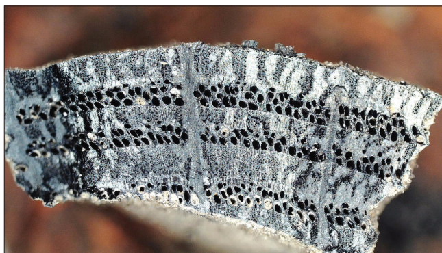
Obr. 8: Příčný řez na dubovém uhlíku. Foto: P. Peška, 2020
