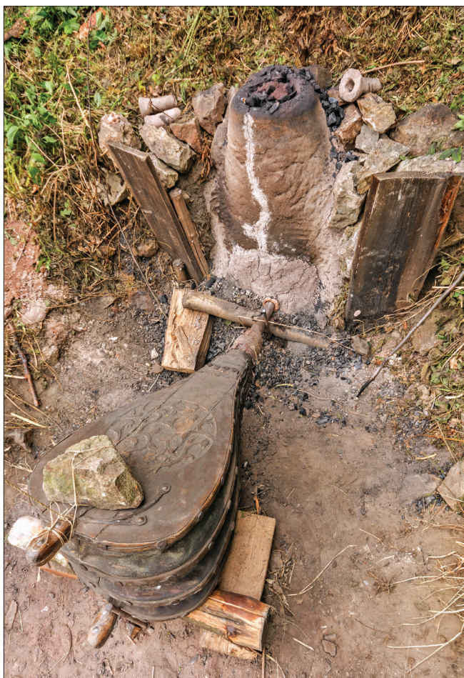
Obr. 1: Rekonstrukce pece typu Somogyfasz (10. – 11. stol.), zbudované a obsluhované maďarskými kolegy, s přistaveným měchem. Nad pecí jsou připravené náhradní dyzny s trychtýřovitě rozšířenými konci. Za pozornost stojí jednoduché aranžmá měchu, umožňující snadnou manipulaci. Stará huť u Adamova 2015. Foto: Martin Barák
