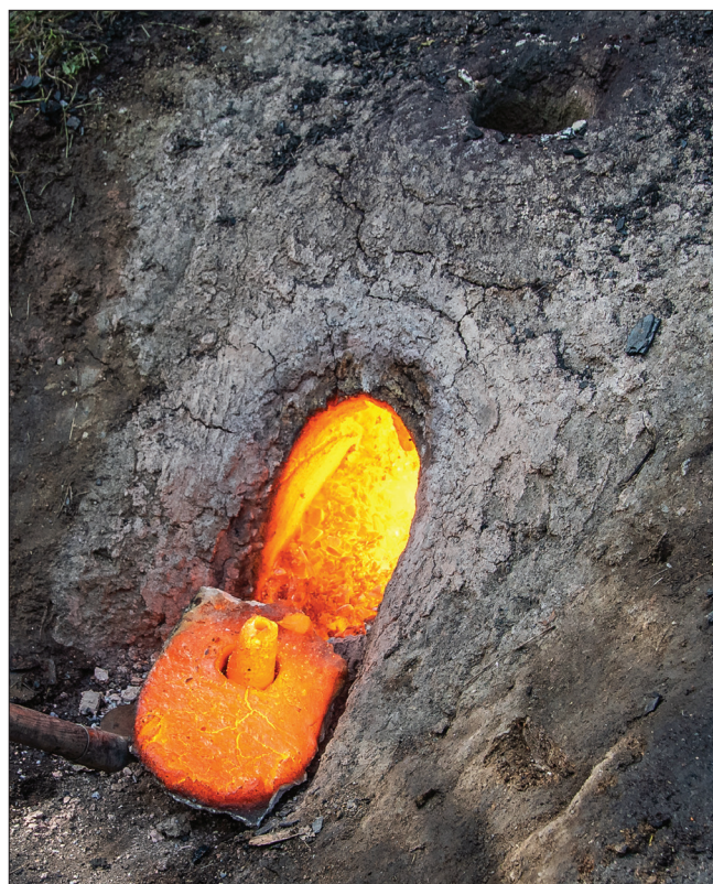
Obr. 16: Právě vylomený štítek pece s tenkou hrudí. Dobře zachovanou dyznu by nejspíše nebylo problémem použít znova. Stará huť u Adamova 2019. Foto: Martin Barák
