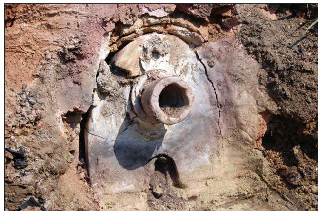
Obr. 13: Vnější strana dyznového štítu s vystupujícím koncem dyzny (a dyznovou vložkou) po ukončení tavby. Na spodní straně dyznového štítu je patrný otvor pro vypouštění strusky, Stará huť u Adamova 2008. Foto: Martin Barák
