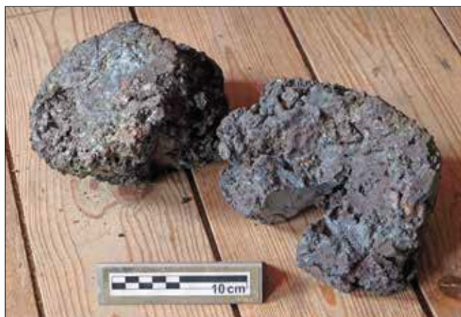
Obr. 3: Dvojice železných lup vyrobených v pátek 25. května 2018. Vlevo lup z pece č. 1 o hmotnosti 5,4 kg (mělký zásek není vidět), vpravo lup z pece č. 2 o hmotnosti 4,2 kg. Při obou tavebách bylo použito 15 kg shodné železné rudy (foto Ondřej Merta)
