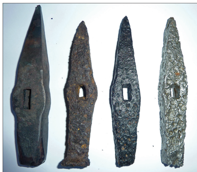
Obr. 2: Srovnání želízka nově vykutého s historickými nálezy (Zlaté Hory – Hackelsberg, Zlaté Hory – Altenberg, Zlatý Chlum, nový výkovek délky 17 cm) (J. Večeřa 2018)
