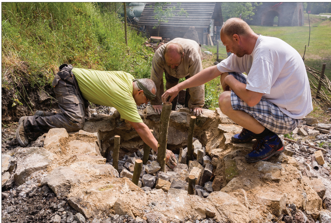
Obr. 1: Stará huť u Adamova, květen 2016, rovnání vsázky do jednokanálové vápenné pece. Foto Martin Barák
