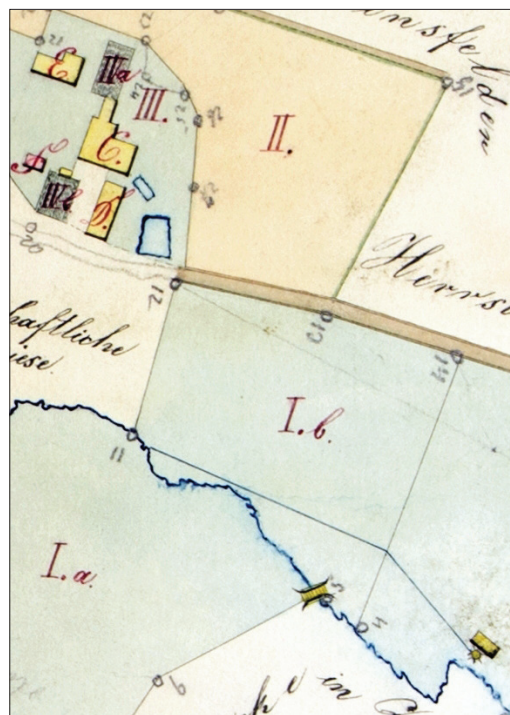
Obr. 15: Výřez z plánu služebních pozemků pohořského revírníka a polesního na Paulině z roku 1854, zobrazující situaci spodní stoupy (dole vpravo), ke které je hnací voda přivedená ve vantrocích (zalomená linie vlevo od stoupy). Pro lepší orientaci je do výřezu zahrnuta situace bývalého hutnímistrovského domu (označeno písmenem „C“)
