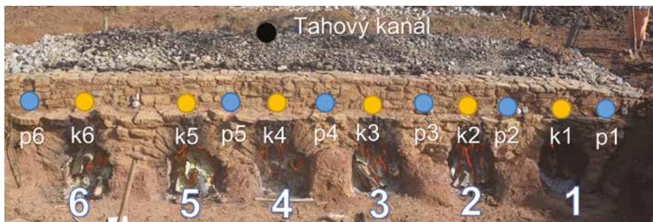
Obr. 18: Rozmístění termočláneků pro monitorování teploty. Foto J. Válek
