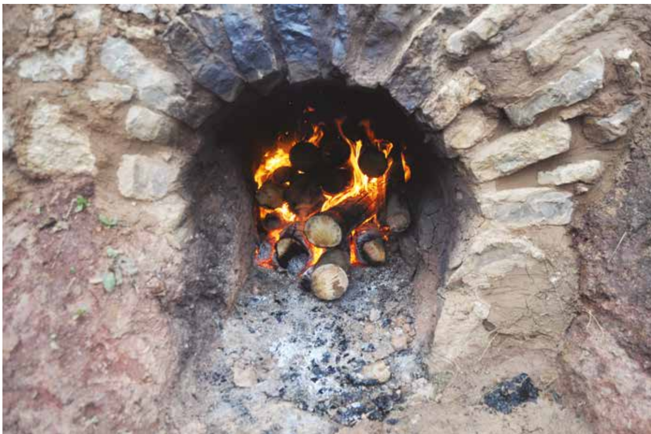
Obr. 12: Ukázkový způsob naplnění topného kanálu palivem. Foto P. Kos
