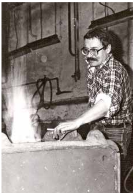
Obr. 16: Experimentální tavby v rekonstrukci raně středověké kusové železářské pece s tenkou hrudí ve slévárně ČKD Blansko pod vedením Věry Souchopové (tehdy Muzeum v Blansku), rok 1986. Při této příležitosti vzniklo přátelství s nestorem slovanského železářství Radomírem Pleinerem, které trvalo po celý život (pan profesor Pleiner zemřel 13. ledna 2015). Tavby blanenského muzea (Věry Souchopové) předznamenal pozdější experimenty v Josefově. V této souvislosti je nutné připomenout i přátelství s dalším významným metalurgem, Karlem Stránským
