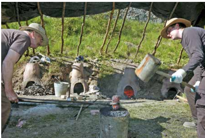
Obr. 28: Stará huť u Adamova, s Martinem Barákem zpracovávají železnou houbu vytavenou v kusové peci, v pozadí experimentální hutnická dílna s pecemi s tenkou hrudí, květen 2011
