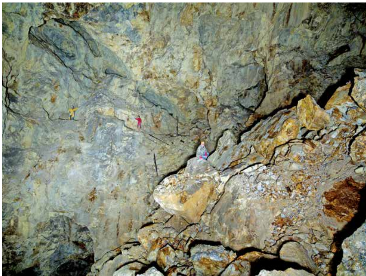
Obr. 21: Velká dobývka Coranda Corhuri s obnaženými starými dobývkami, Carnic. Celková výška komory Corhuri je téměř přesně 300 metrů. (723 až 1023 m.n.m.). Foto I. Rous
