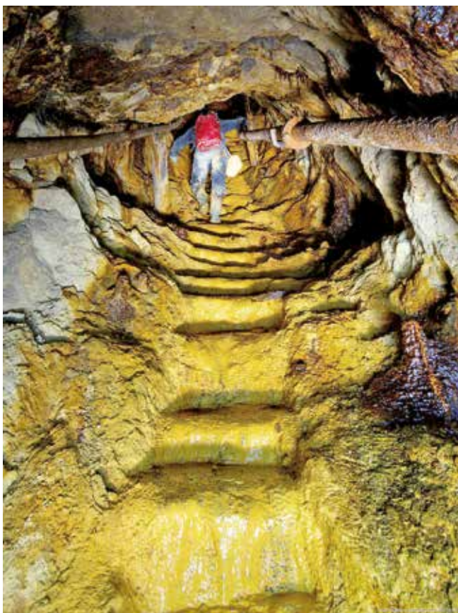
Obr. 17: Stará úpadnice spojující štoly jednoho těžarstva. Spojnice štol Verchesul de sus (Felső Verkes a Razna (Alsó Verkes)). Foto I. Rous
