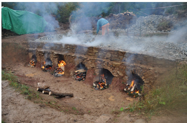
Obr. 3: Počáteční fáze výpalu, po vrcholu vsázky je dosud možné se pohybovat, Mokrá-Horákov, okr. Brno-venkov. Foto P. Kos 2014
