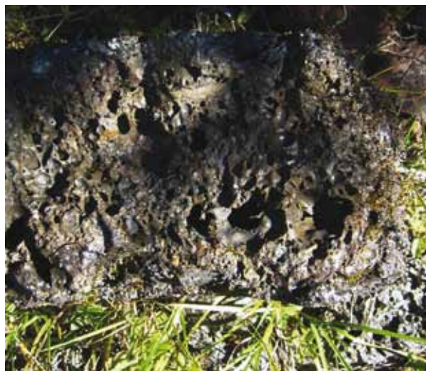
Obr. 17e: Struska z taveb stříbrných nebo kobaltových (?) rud, „tvárnice“, novověk, Soví huť, Nové Hamry, Krušné hory. Foto M. Gelnar 2010
