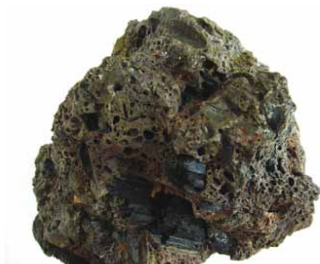
Obr. 17d: Struska z taveb stříbrných nebo kobaltových (?) rud se zbytky dřevěného uhlí, novověk, Soví huť, Nové Hamry, Krušné hory. Foto M. Gelnar 2010
