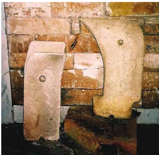
Obr. 3: Clonka a zobák, žáruvzdorná keramika, současná produkce. Foto M. Gelnar
