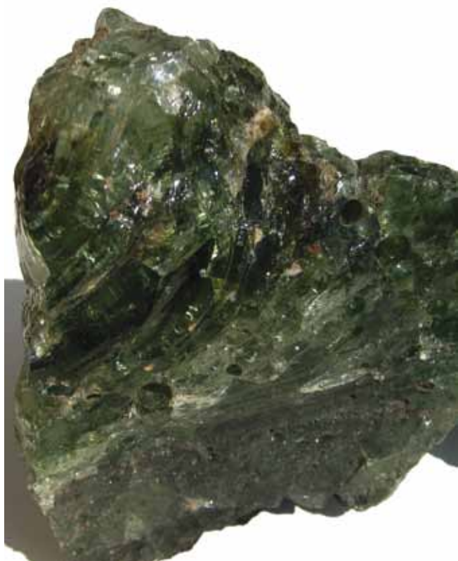
Obr. 14d: Tavenina zv. nístějové sklo, vytekla do nístěje pece, skelné jímky či topného kanálu, 19.–20. století, Lužické hory. Foto M. Gelnar
