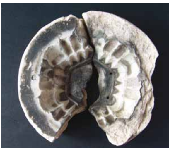
Obr. 10c: Keramická forma na šestihrannou misku s laločnatým okrajem, na dně s uhlíkatou vrstvou spálené pryskyřice a dírkami pro odvod kouře, 1750–1875 Nová Huť, Lužické hory. Foto M. Gelnar
