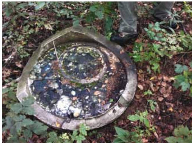
Obr. 8a: Dno sklářské pánve se zbytkem skla a šamotovým kroužkem, 1893 – mezi válkami, sklárna Tereza fy. Knöspel Kytlice-Mlýny, Lužické hory, foto archiv M. Gelnara
