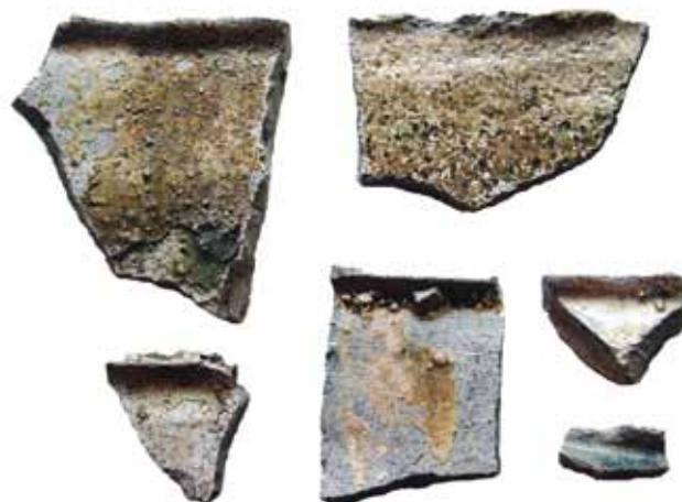
Obr. 5b: Zlomky okrajů sklářských pánví s korozní rýhou, středověk, Naděje II., Lužické hory. Foto M. Gelnar
