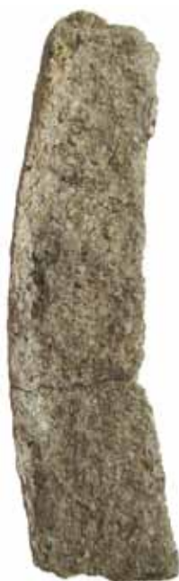
Obr. 5d: Profil s okrajem sklářské pánve, středověk, jako ostřívo použitý drcený křemen, Svor IV., Lužické hory. Foto M. Gelnar
