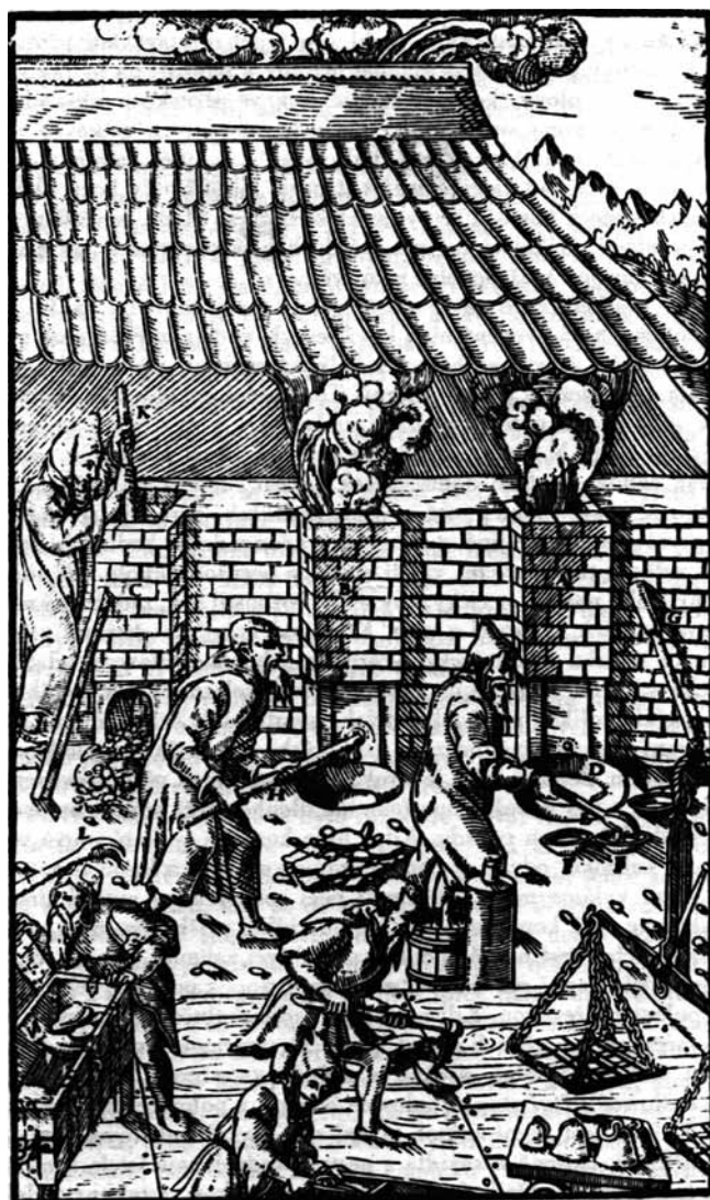
Obr. 24: Vyobrazení huti z poloviny 16. století přináší známá práce Jiřího Agricoly. I když se zde (tak jako nejspíše i na rožňavském obraze) jedná o huť zpracovávající stříbrné rudy, můžeme předpokládat, že její vzhled odpovídá železářským hutím pozdně středověkého a raně novověkého období (Agricola 1933, 383; originál vydán roku 1556)
