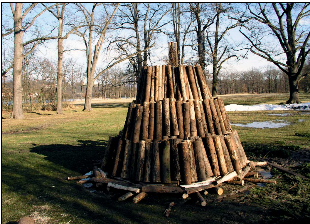
Obr. 5 Stavba experimentálního milíře ze smrkového dřeva. Ohrada u Hluboké nad Vltavou. Foto J. Woitsch, 2007
