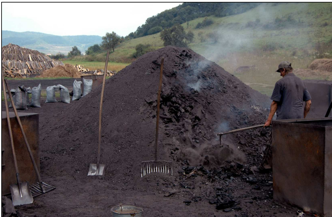
Obr. 4 Rozebírání vypáleného milíře; v popředí typické uhlířské nástroje. Uhlířské pracoviště poblíž obce Valchid, oblast Transylvánie, Rumunsko. Foto J. Woitsch, 2005
