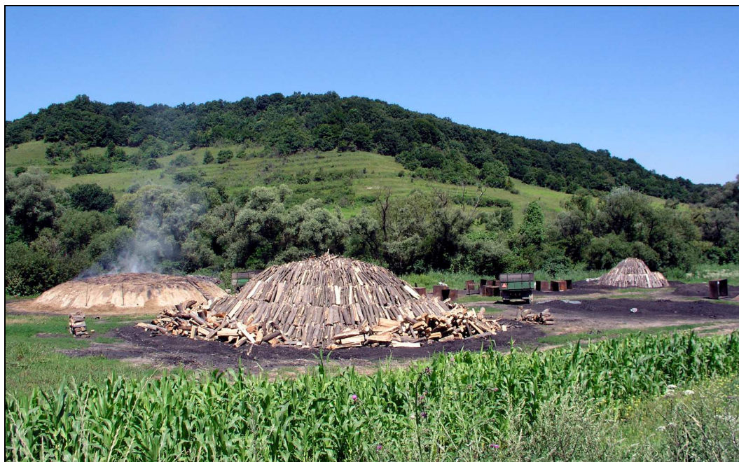
Obr. 3 Celkový pohled na uhlířské pracoviště s kontinuální komerční výrobou dřevěného uhlí tradičními technologiemi. Několik milířů se nachází v různých fázích zpracování (stavba, vypalování, rozebírání). Uhlířské pracoviště poblíž obce Valchid, oblast Transylvánie, Rumunsko. Foto J. Woitsch, 2005
