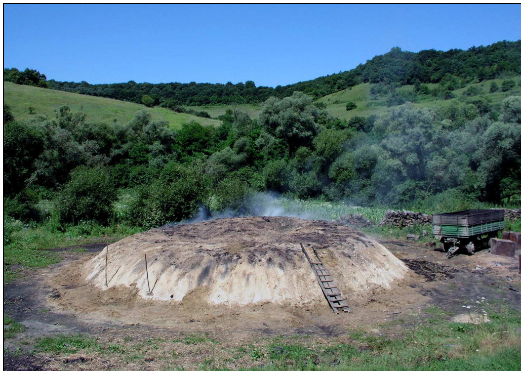
Obr. 2 Stojatý milíř ve střední fázi vypalování. Uhlířské pracoviště poblíž obce Valchid, oblast Transylvánie, Rumunsko. Foto J. Woitsch, 2005
