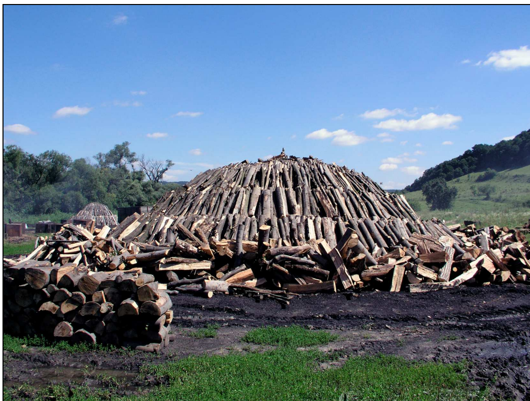
Obr. 1 Stojatý milíř z bukového dřeva před pokrytím těsnící vrstvou. Uhlířské pracoviště poblíž obce Valchid, oblast Transylvánie, Rumunsko. Foto J. Woitsch, 2005
