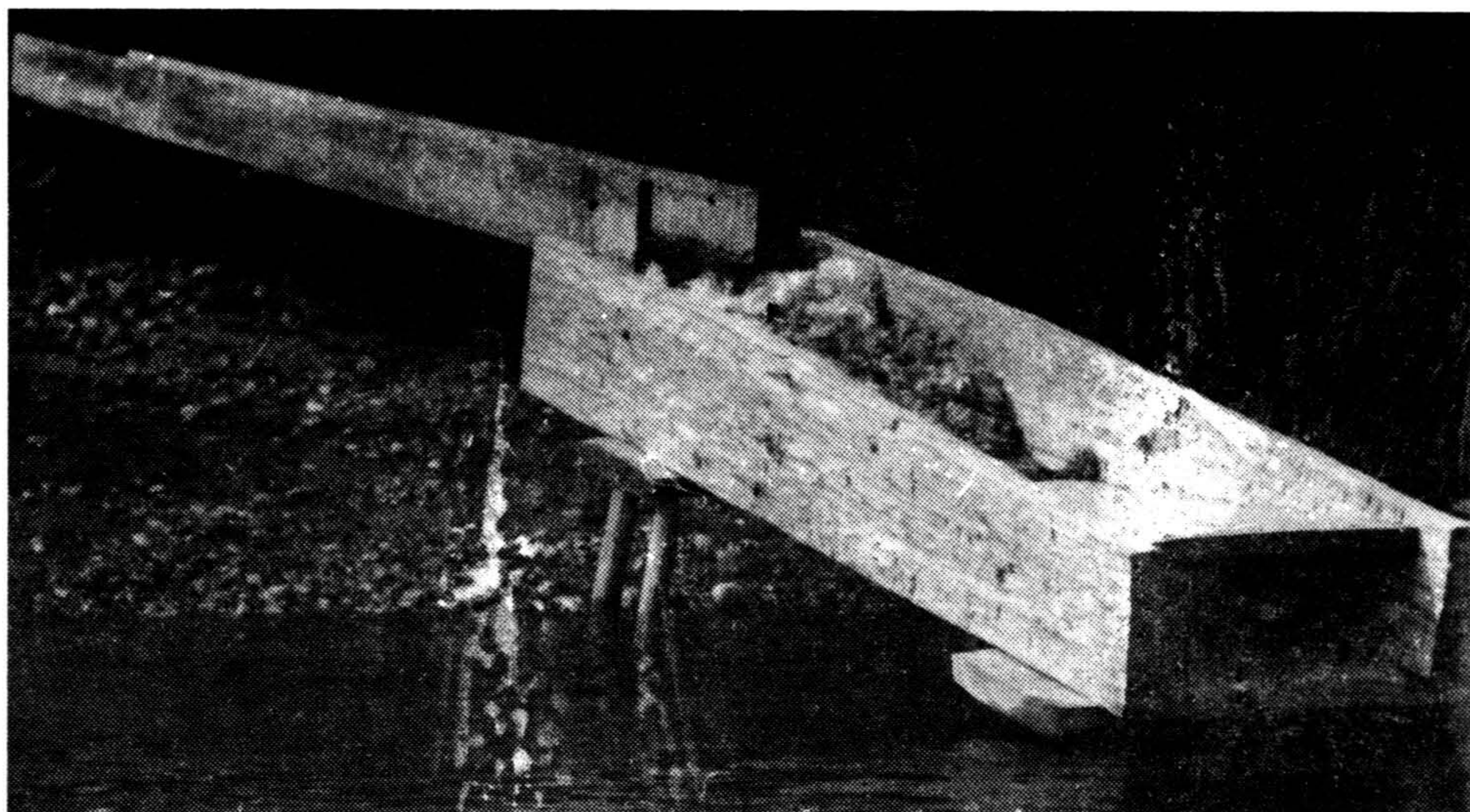
Obr. 4 Rekonstruovaný rýžovnícký splav z Modlešovic během experimentu u Kestřan na Otavě v létě roku 1987
